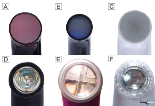
FIGURA 6. Puntas de fotocurado LED. A- Bluephase Style. B- ESPE Cordless. C- Elipar S10. D- Demi Ultra. E- Valo Cordless. F- Radii-Cal. Observe los diferentes diámetros. Fuente: tomada de André et al. (2018, p. 401).
