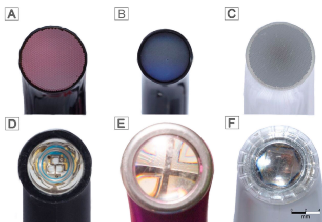
FIGURA 6. Puntas de fotocurado LED. A- Bluephase Style. B- ESPE Cordless. C- Elipar S10. D- Demi Ultra. E- Valo Cordless. F- Radii-Cal. Observe los diferentes diámetros. Fuente: tomada de André et al. (2018, p. 401).
