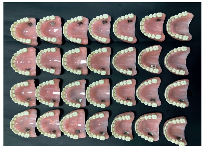
FIGURA 2. Preparación de parte de la muestra para la exposición térmica
