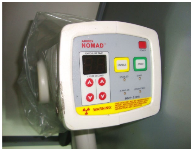
FIGURA 2. Menú digital de control del NOMAD™. Fuente: Los autores.
