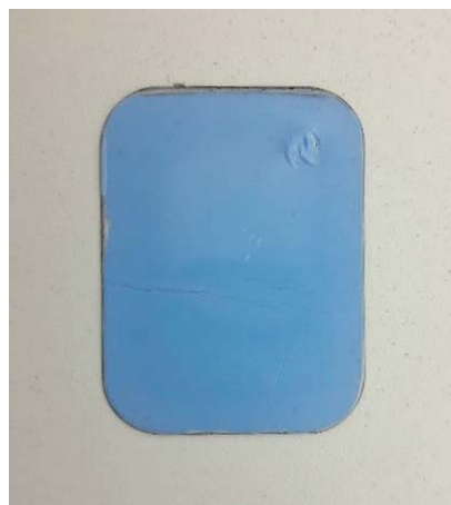
FIGURA 2. Sensor de estado sólido o placa PSP. Fuente: Los autores.
