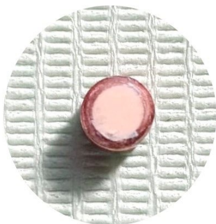
FIGURA 1. Probeta de Biodentine sobre la cual se realizó la prueba de dureza Vickers.
