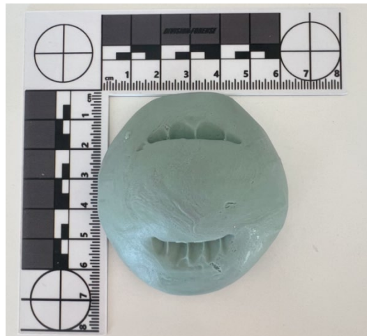
FIGURA 6. Impronta sobre capa de silicona adaptada sobre la pelota de goma elástica.
