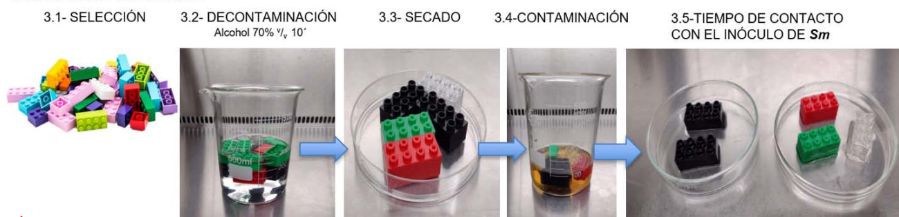
FIGURA 2. Descontaminación del fómite por inmersión en alcohol etílico 70%V/V.- Secado bajo aire estéril en cabina biológica. - contaminación por inmersión con inóculo estandarizado. - colocación del fómite tratado sobre placas estériles.
