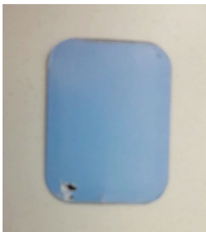
FIGURA 6. Placa PSP con daño ostensible en su estructura. Fuente: Los autores.
