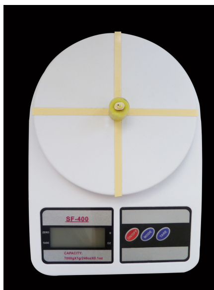
FIGURA 7. Dispositivo utilizado para fijar los postes
